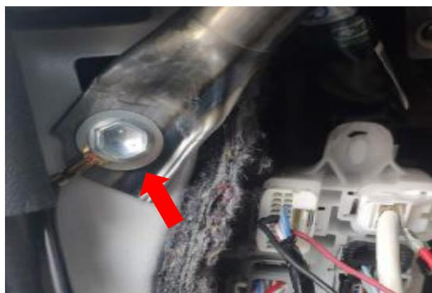
接负极：A柱附近找到不带油漆的螺栓连接负极(箭头)
