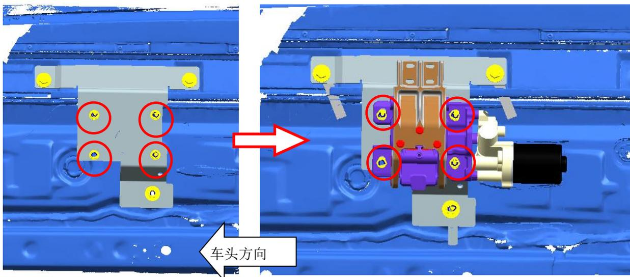
2、安装支架组件三:把支架组件三与左后支架连接，首先拆下左前支架上的四个 M10 螺母、D10 弹簧垫、D10 平垫片，然后装上铝支架组件三，用拆下的标准件锁上，注意先不锁紧，待安装踏板最后拧紧；提示：用同样方法安装另一边把支架组件三与右后支架连接，用 D10 平垫片、D10 弹簧垫、M10 螺母锁上，待安装踏板最后锁紧；
