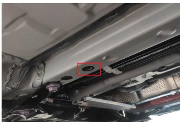
车底穿线孔: 如图示意左穿线孔位置 (车外)
