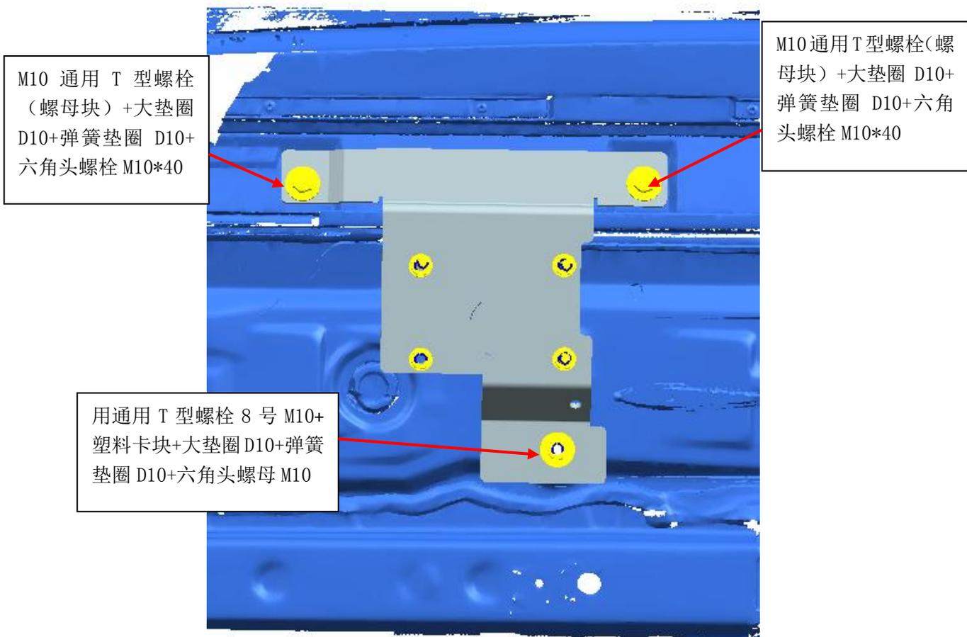
**(4) 安装后支架 (左)(左右两边安装方法一样)**
