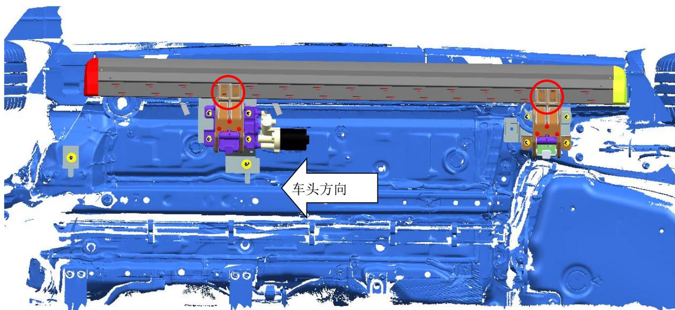
**第六步：安装护板：**把原车护板比在车身对应位置，干涉部位做好记号并割掉再安装回去；
