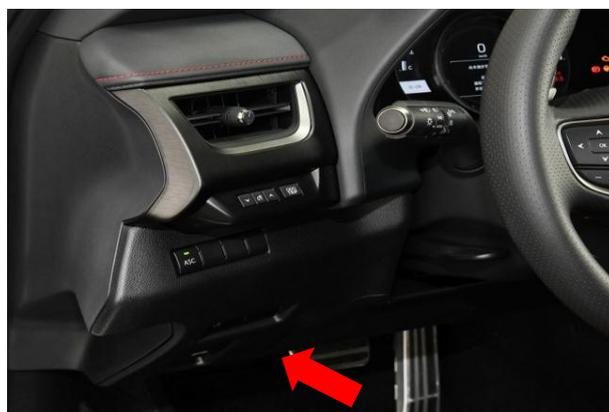
ECU 安装位置: 在驾驶室内部找到合适固定位置利用扎带或 3M 胶固定 ECU, 最后还原内饰
