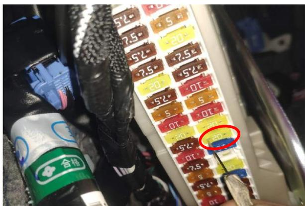
接正极线：拔出原车保险丝(红圈)插到我司保险丝取电器并把取电器安装到保险盒上
