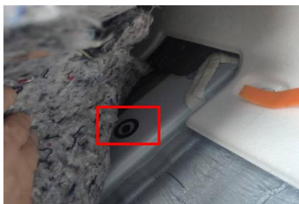
车底穿线孔: 如图示意右穿线孔位置 (车内)
