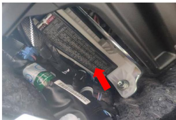
接正极线：拆下黑色盖板(箭头)，**注意保管好盖板**
