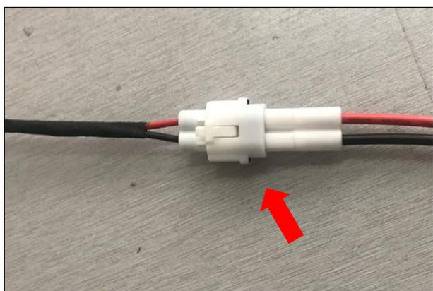
左右电机接线方法: 把两边端头颜色一一对应接驳, 电机线红色线接红色线, 黑色线接黑色线 (箭头)
